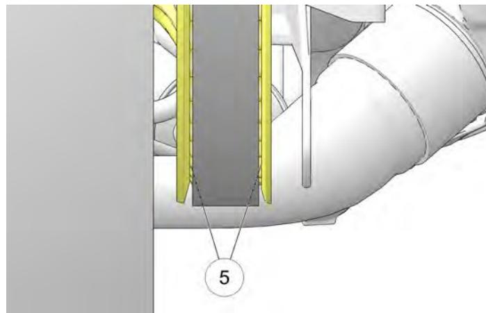
3. Se necessario, allentare il dado dell'asse e il dispositivo di regolazione LATO SINISTRO finché la cinghia non si stacca dalla flangia destra ed inizia ad allinearsi al centro della flangia portacorona condotta, durante la rotazione in avanti della ruota.
