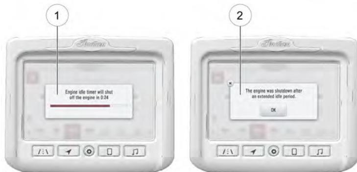
Sulle motociclette equipaggiate con Ride Command, verrà visualizzata una notifica con un conto alla rovescia per informare che il motore sta per spegnersi ①. Una volta trascorso il tempo e spento il motore, verrà visualizzata un'ulteriore notifica ②. Una volta spento, il motore può essere riavviato premendo l'interruttore di avviamento.
