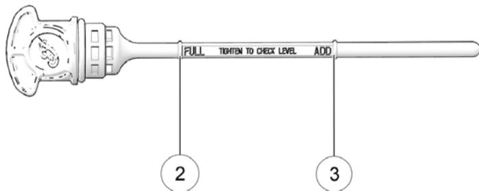
7. Reinstallare saldamente l'astina.
