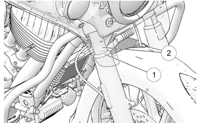
2. Pulire i tubi della forcella per rimuovere insetti, catrame o depositi che possono causare l'usura della tenuta o perdite. Ispezionare le superfici esterne dei tubi interni delle forcelle per graffi o danni causati da corpi estranei.
