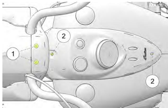
3. Rimuovere i due dispositivi di fissaggio ② che fissano il coperchio della console al serbatoio del carburante e sollevare e allontanare la console per posizionarla sul serbatoio del carburante protetto.
