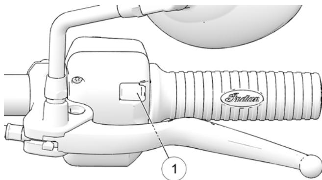
Il blocchetto di accensione deve essere in posizione ON perché i comandi a levetta possano funzionare. Usare il comando sul lato destro per navigare attraverso i menù o accettare le finestre di dialogo sul display Ride Command. Usare il comando sul lato sinistro per uscire dai menù, rifiutare le finestre di dialogo, riagganciare il telefono, e spostarsi tra le schermate del display.
