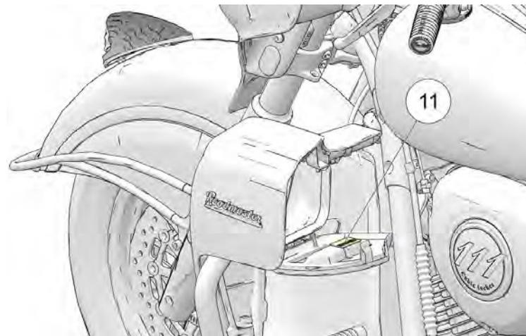
⑪ Etichetta della capacità del cassetto ripostiglio sulla carena inferiore (coperchi interni)
