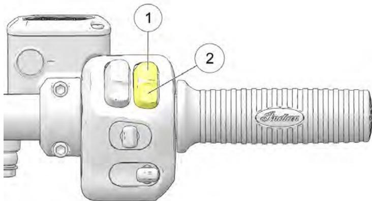
Premere la parte alta dell'interruttore (STOP) ① per aprire i circuiti e arrestare il motore. Il motore non si avvia e non si mette in funzione quando l'interruttore è nella posizione STOP.
