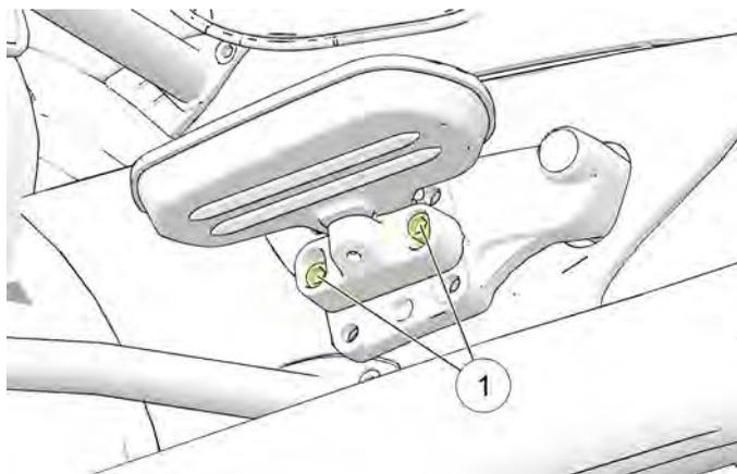
Per regolare l'altezza, rimuovere entrambe le viti di montaggio. Spostare il gruppo pedana nella posizione del foro successivo, quindi reinstallare i dispositivi di fissaggio, regolare l'angolazione e serrare i dispositivi di fissaggio.
