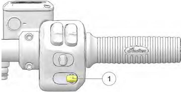
Premere l'interruttore in alto per regolare il parabrezza alzandolo. Premere l'interruttore in basso per regolare il parabrezza abbassandolo. Picchiettare l'interruttore due volte in alto o in basso per regolare automaticamente il parabrezza alzandolo o abbassandolo completamente. Se il parabrezza è in movimento e viene brevemente premuta la direzione opposta, il movimento automatico viene annullato.
