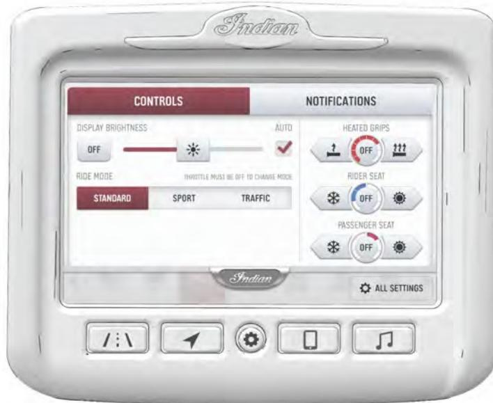
Dal Pannello di Controllo è possibile accedere alle impostazioni, regolare la luminosità del display, selezionare la modalità di guida, e comandare il climatizzatore.
