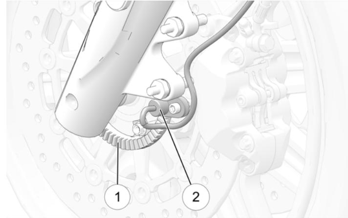
2. Ispezionare per presenza di detriti sulle estremità dei sensori di velocità ruote ②. Se c'è contaminazione oppure risulta non possibile effettuare un'ispezione visiva, strisciare un sottile strofinaccio attraverso la superficie del sensore situata tra il sensore stesso e la ruota fonica per rimuovere eventuali detriti.
