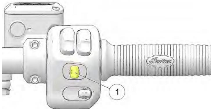
Il cruise control può essere attivato e regolato tramite i comandi sul lato destro usando l'interruttore cruise control ①.
