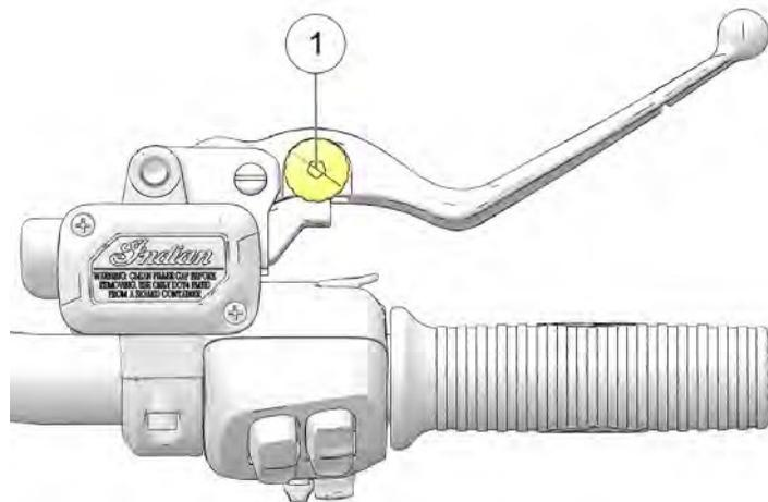
La portata della leva freno anteriore (distanza dalla manopola) è regolabile. Per regolare la portata della leva freno anteriore, procedere come segue:
